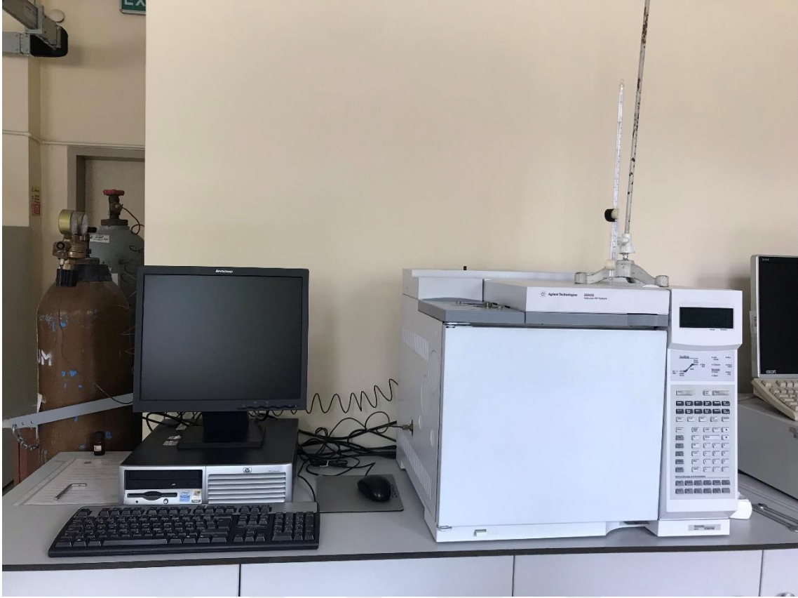
Şekil 4. 1 Hewlett-Packard 6890 N model, gaz kromatografi cihazı
