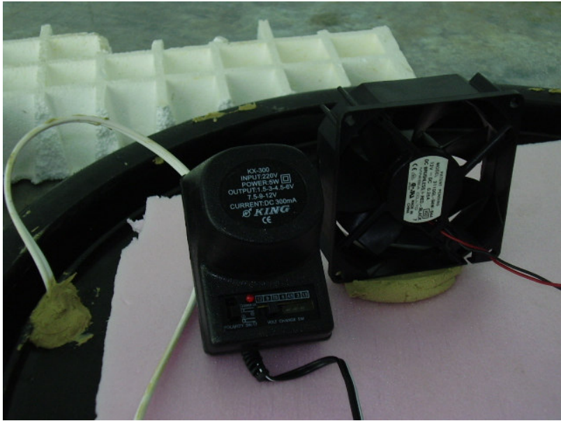
Şekil 3.3. Uygulamada hava hareketini sağlayan fan ve adaptör
