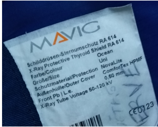
Şekil 5.2 Kullanılan koruyucu zırhın etiket bilgileri
