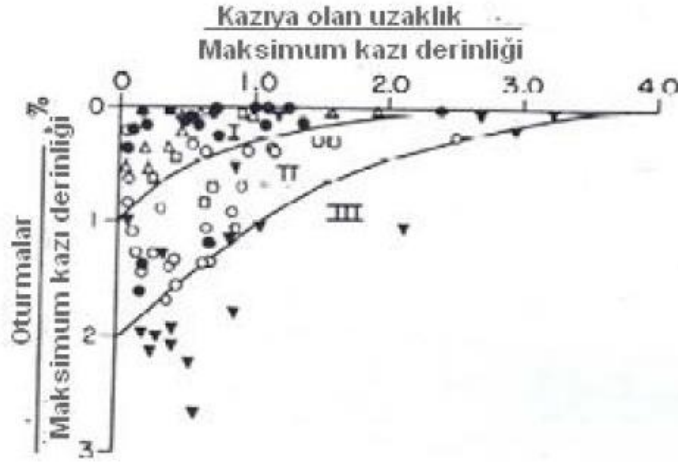
Şekil 1.1 Kazıya olan uzaklığa bağlı oturmalar [1]
