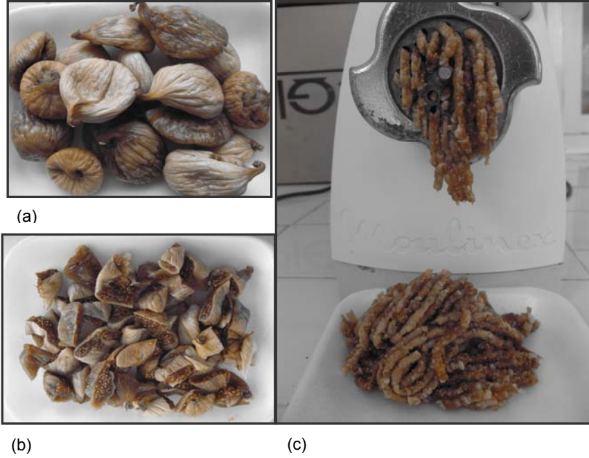
Şekil 3.4. Kimyasal analizler için örneğin hazırlanması. (a) Paçal partinin iyice karıştırılması, (b) parçalama, (c) ezme haline getirme.
