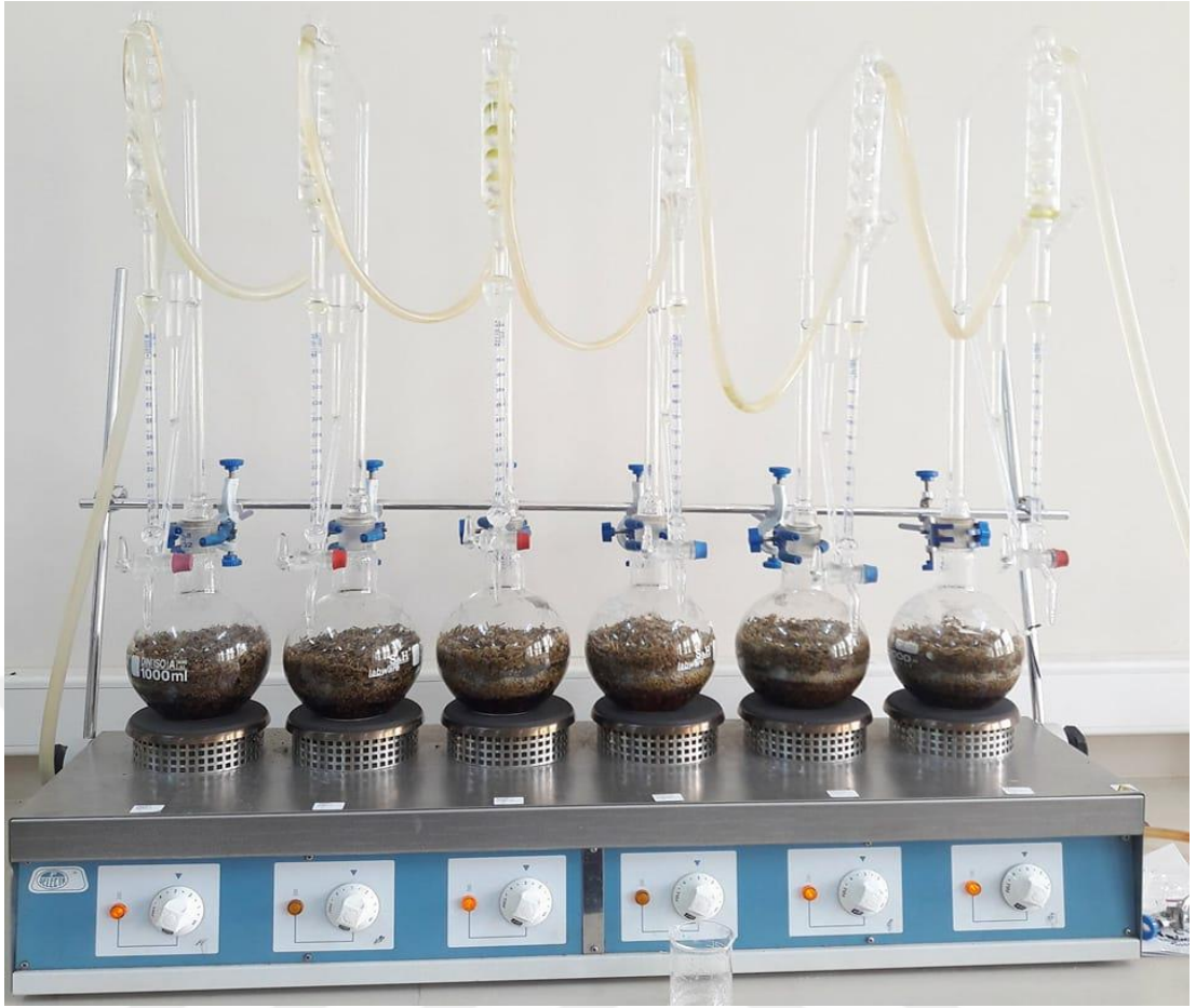
Şekil 3.7. Tıbbi adaçayı yapraklarının Clevenger cihazında damıtılması
