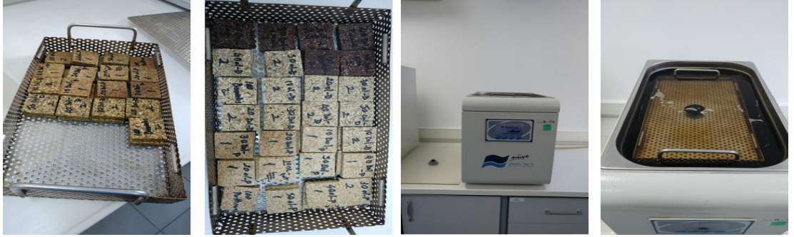
Şekil 3.2. Deneme örneklerinin su içinde kalınlık artım deney düzeneği
