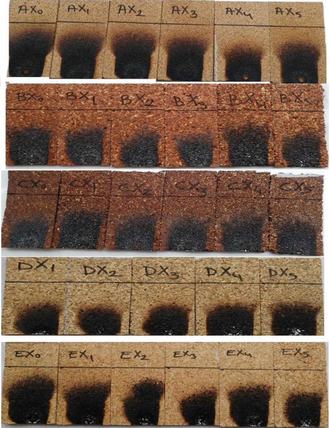
Şekil 4.11. Dolomit ilavesiyle üretilmiş ve tek alev kaynağına maruz kalmış levhaların davranışı
