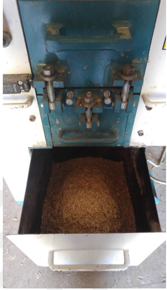
Şekil 3.2. Kermes meşesi gövdelerinin yongalanması (Foto: G. GÜLER)
