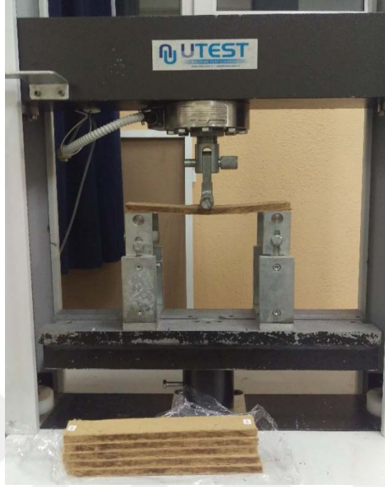
Şekil 3.8. Eğilme direnci ve eğilmede elastikiyet modülü tayini (Foto: A. BERAM)
