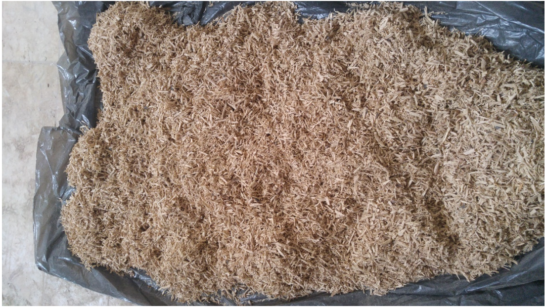
Şekil 3.3. Yongaların serilerek kurutulması (Foto: G. GÜLER)
