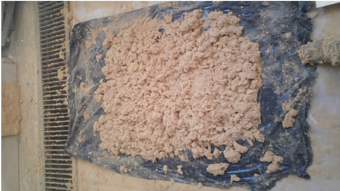
Şekil 3.5. Liflerin serilerek kurutulması (Foto: G. GÜLER)
