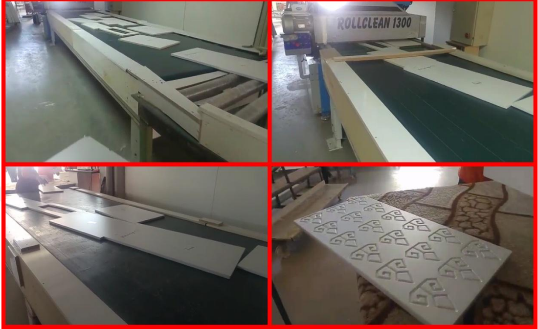
Şekil 4.15. Folyo kaplanan iş parçasının temizliği ve son işlemler
