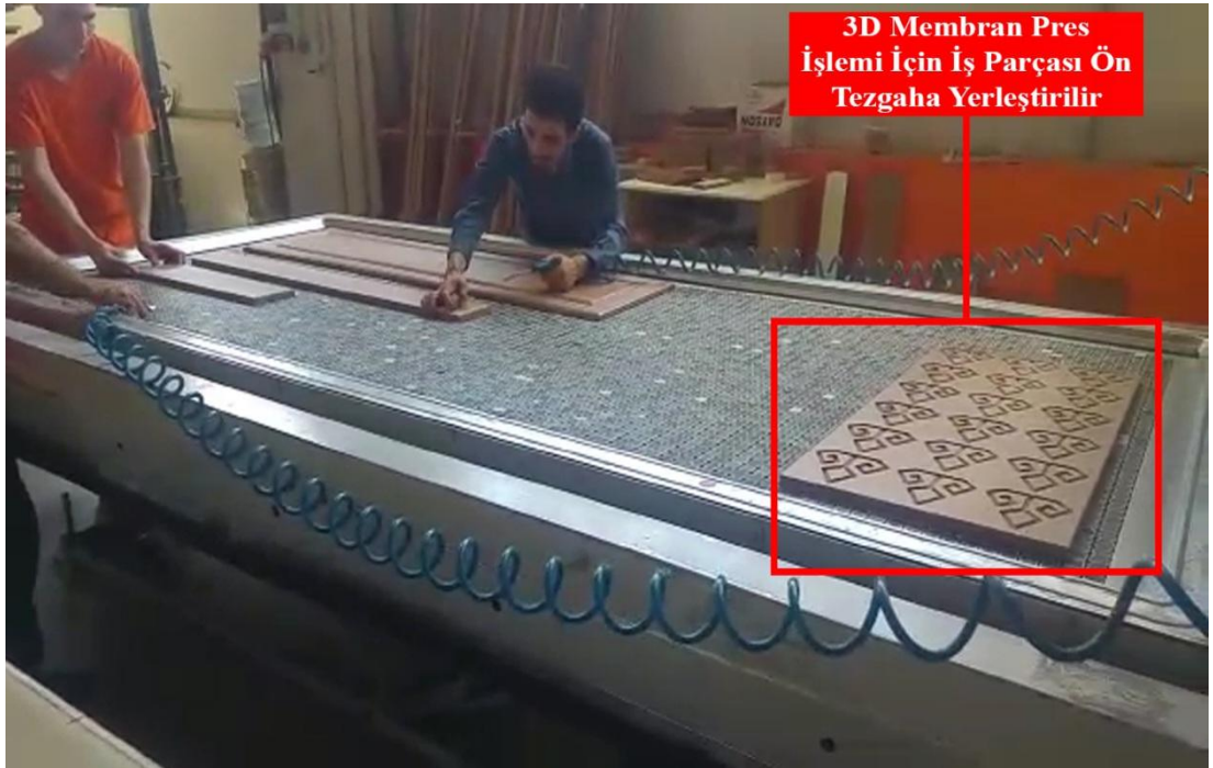
Şekil 4.11. Pres makinesinin ön tablasına malzemenin yerleştirilmesi
