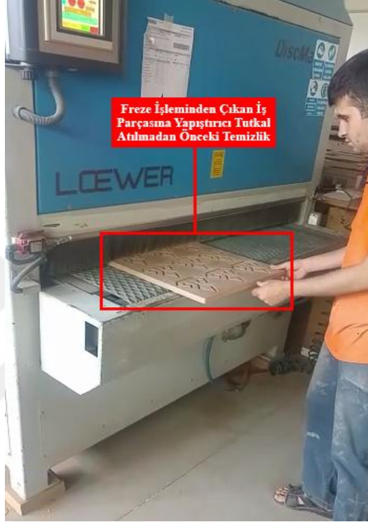
Şekil 4.9. Yapıştırıcı tutkal atılmadan önce yüzeyde yapılan temizlik
