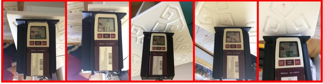
Şekil 4.18. İş parçasının yüzeyi kaplandıktan sonraki pürüzlülük ölçümü
