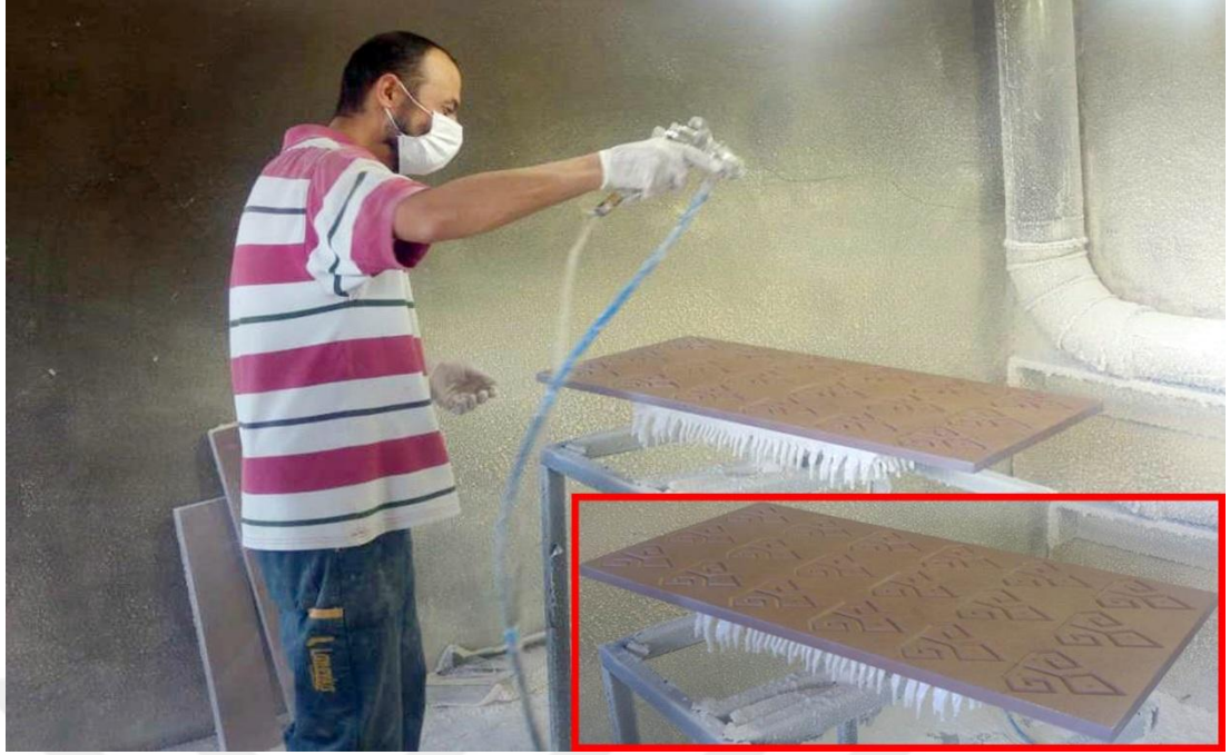
Şekil 4.10. İşlem görmüş yüzeye tutkal pulverizasyonu yapılması
