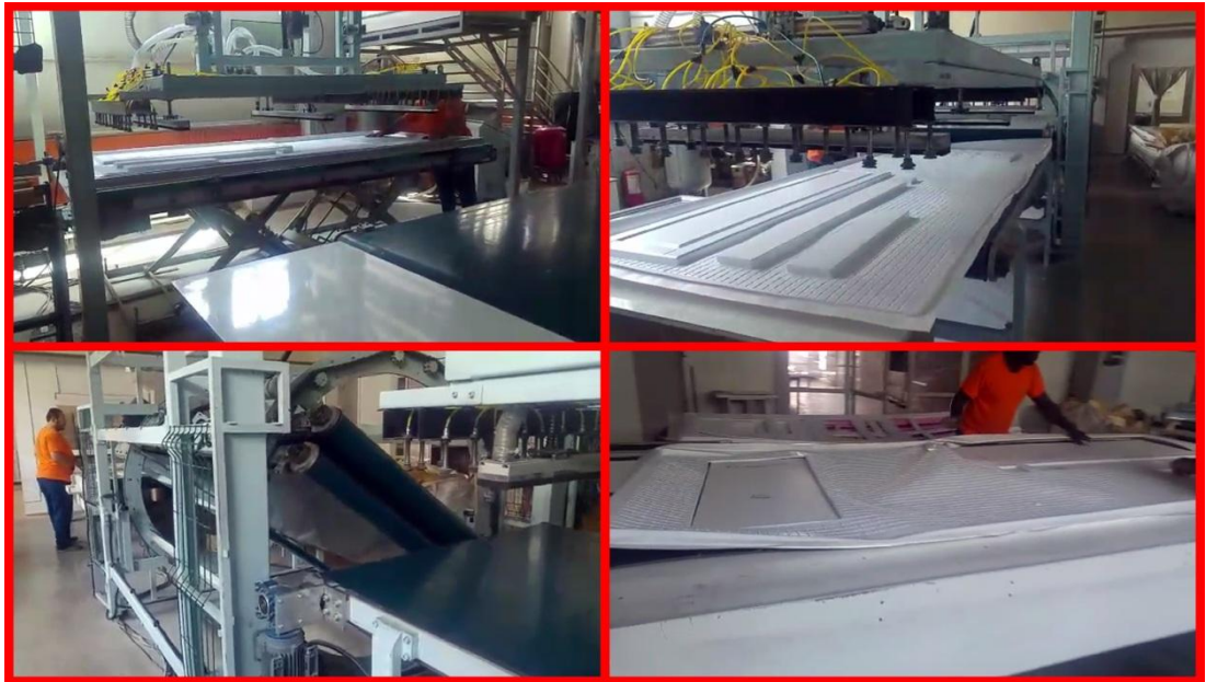
Şekil 4.14. Baskıdan çıkan iş parçasının folyodan ayrılması için yapılan temizlik
