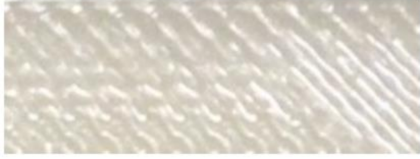
Şekil 3.4 FDM yöntemiyle üretilmiş ABSplus malzemesinin yüzeyi
