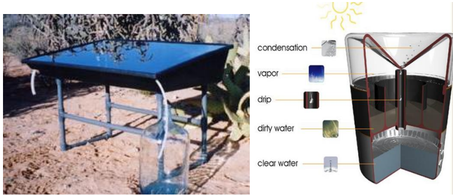
Şekil 4.12. Güneş su arıtma düzeneği
