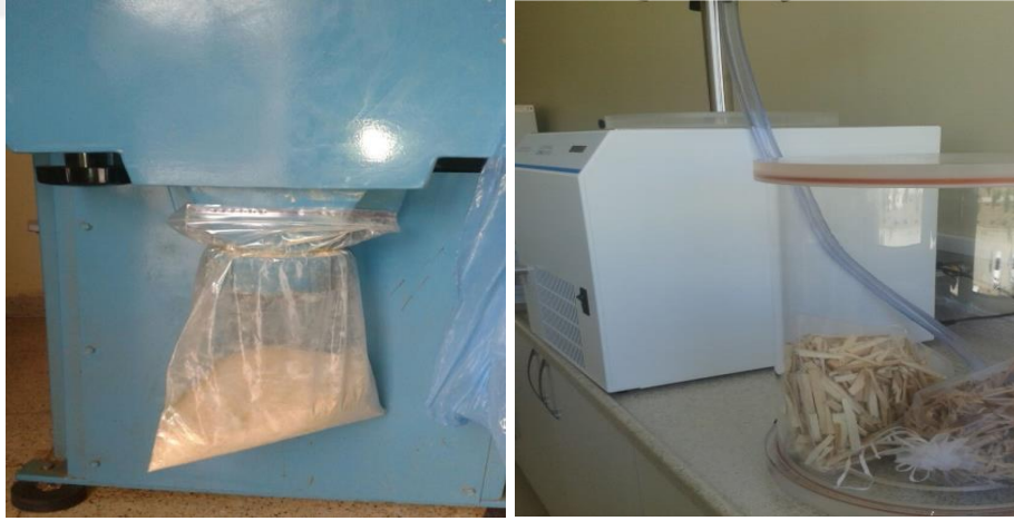
Şekil 4.2. Örnekleri öğütmekte kullanılan wiley değirmeni ve kurutmak için kullanılan freeze dryer (Salman, 2017)
