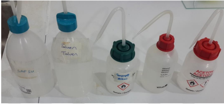
Şekil 3.6. Alttaş temizleme işleminde kullanılan malzemeler
