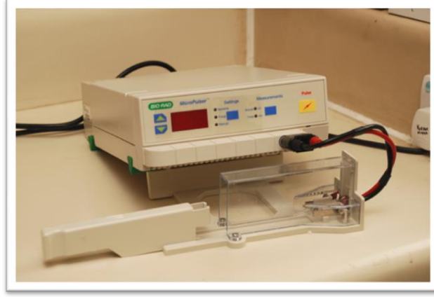
Şekil 3.1. NAC genine spesifik DNA'yı içeren pCAMBIA 1304 ikili vektörünün Agrobacterium tumefaciens hücrelerine aktarılmasında kullanılan elektroporatör cihazı
