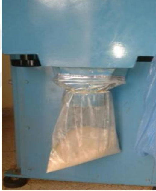
Şekil 3.10. Örnekleri öğütmekte kullanılan Wiley değirmeni ve öğütülmüş örnekler
