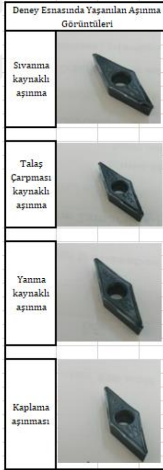
Şekil 4.4. Kesici takımda karşılaşılan aşınma görüntüleri
