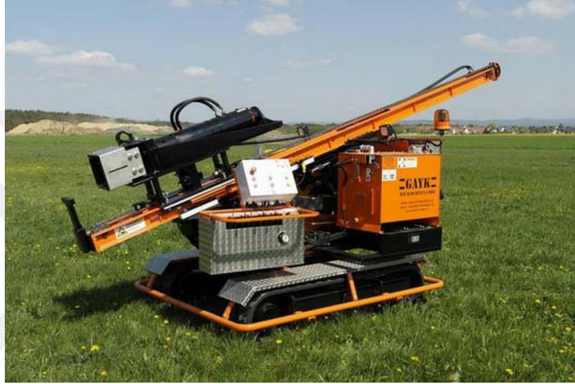
Şekil 3.17. Çakma işlemini uygulayan makinelerden gayk (Erenetürk, 2019)
