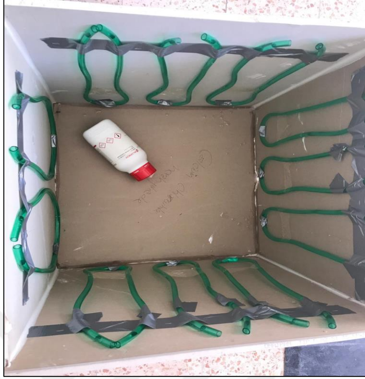
Şekil 3.3. Oda içerisine yerleştirilen silikon hotrumlar ve Calcium Chloride hexahydrate
