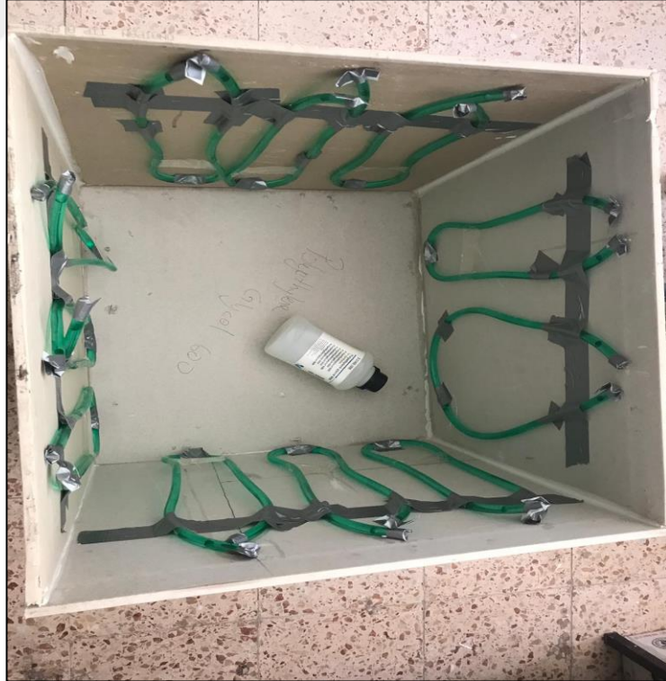
Şekil 3.2. Odaya yerleştirilen silikon hotrumlar ve polyetilene glycol 600
