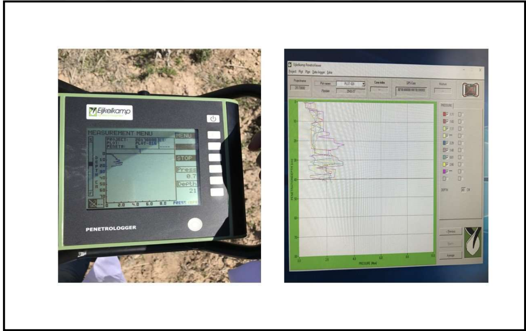
Şekil 3.6. Penetrasyon direnci ölçümleri
