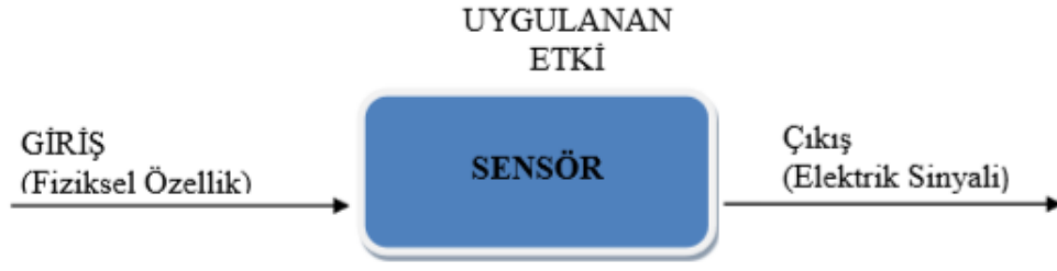
Şekil 2. 1 Bir sensörün çalışma prensibi [10]
