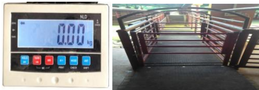
Şekil 3.2. Canlı ağırlığın alındığı tartı başlığı ve platformu
