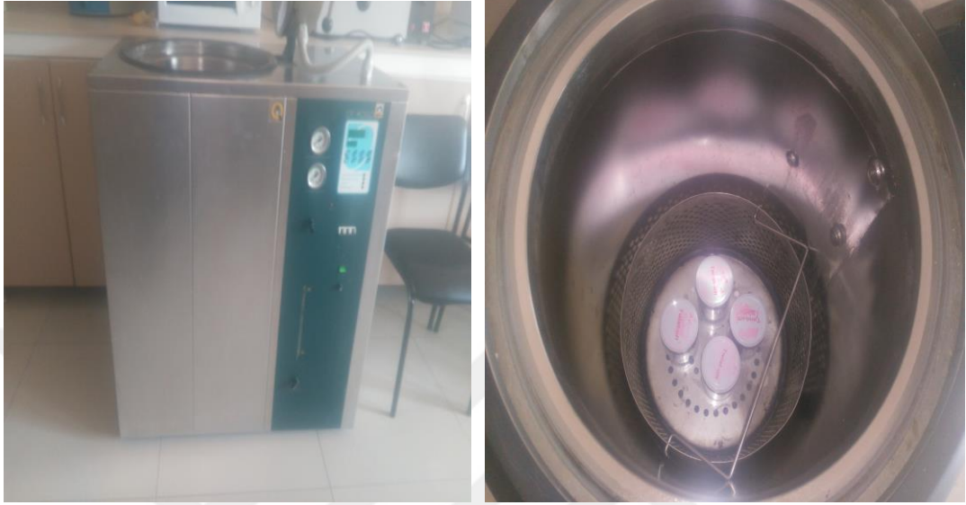
Şekil 3.3. Yem örneklerinin otoklav ile muamelesi
