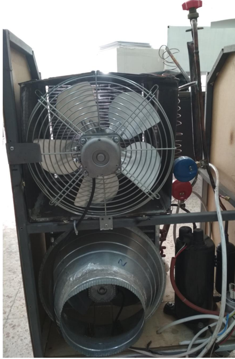
Şekil 5.2. Mikro kanallı buharlaştırıcıya sahip sistemin hava akışı için kullanılan fanların yerleşimi.
