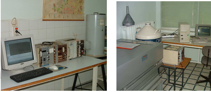
Şekil 3.10 a) NaI(Tl) sintilasyon dedektörlü b) HPGe dedektörlü gama spektrometre sistemi.
