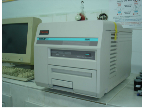
Şekil 3.4 Işıma ölçümlerinin yapıldığı TLD okuyucu sistemi (Harshaw TLD 3500).
