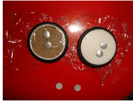
Şekil 3.15 Doğrudan metot ile yıllık doza beta katkısının hesaplanması için hazırlanan örnekler.
