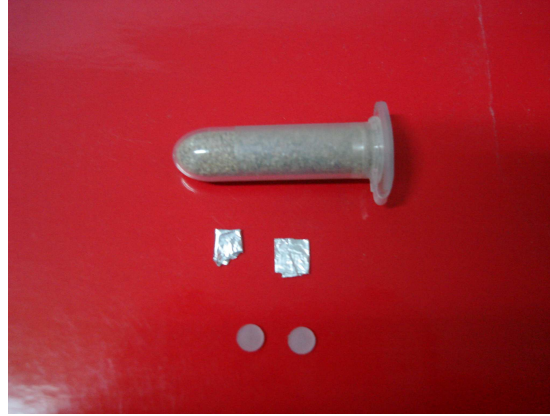
Şekil 3.12 Doğrudan metot ile yıllık doza gama katkısının belirlenebilmesi için hazırlanan \alpha\text{-Al}_2\text{O}_3\text{:C} dozimetreler.
