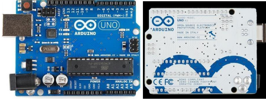
Şekil 6.3. Arduino Uno R3 önden ve arkadan görünüşü (Roboweb, 2018)
