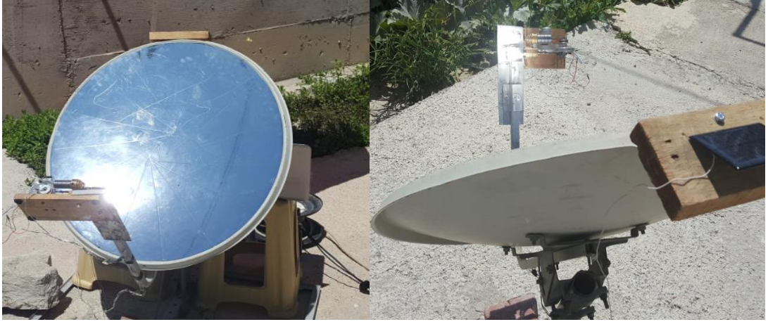
Şekil 7.8. Odak noktasına konumlandırılan Stirling motor
