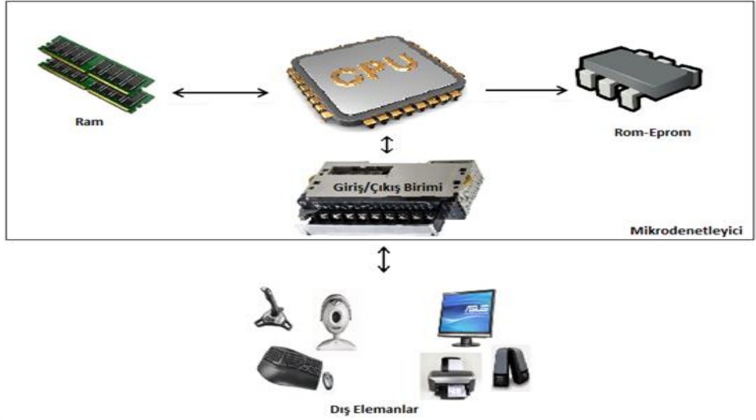
Şekil 1.6. Mikrodenetleyicinin blok şeması (Topaloğlu, 2006).
