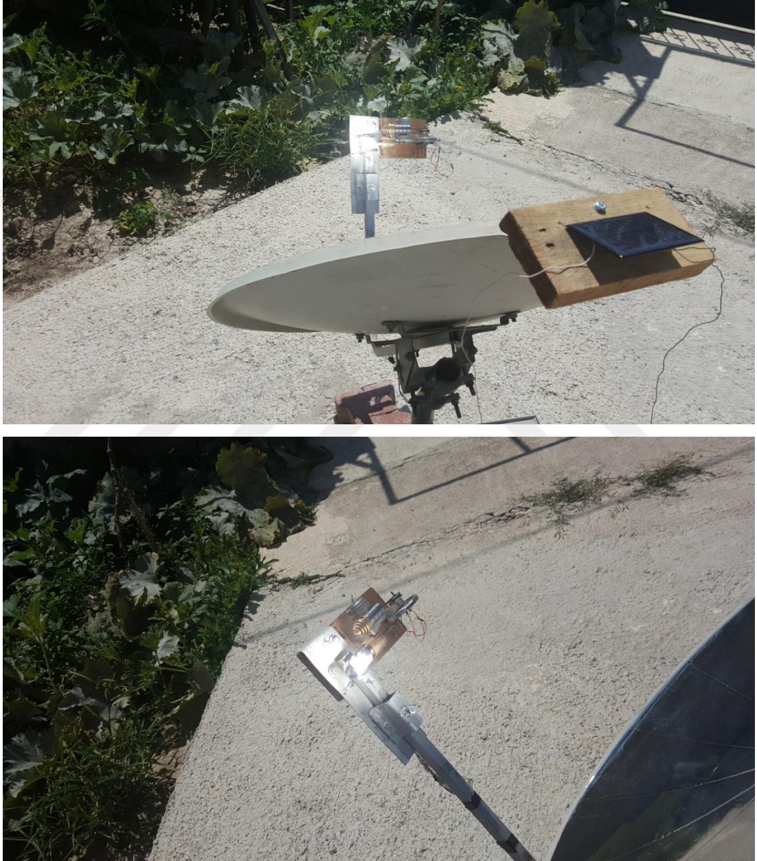
Şekil 8.2. Odak noktasına gelen güneş ışınlarının toplanması
