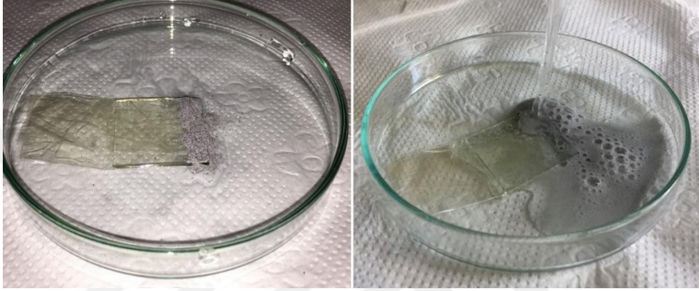
Şekil 3.7. Aşındırma (etching) işleminin ITO kaplı alttaşlara uygulanması
