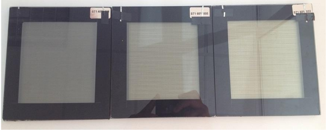
Şekil 1.8. Değişik şeffaflık oranlarına sahip ince film güneş hücreleri (Soldan sağa sırası ile %40, %60 ve %80 şeffaflık)
