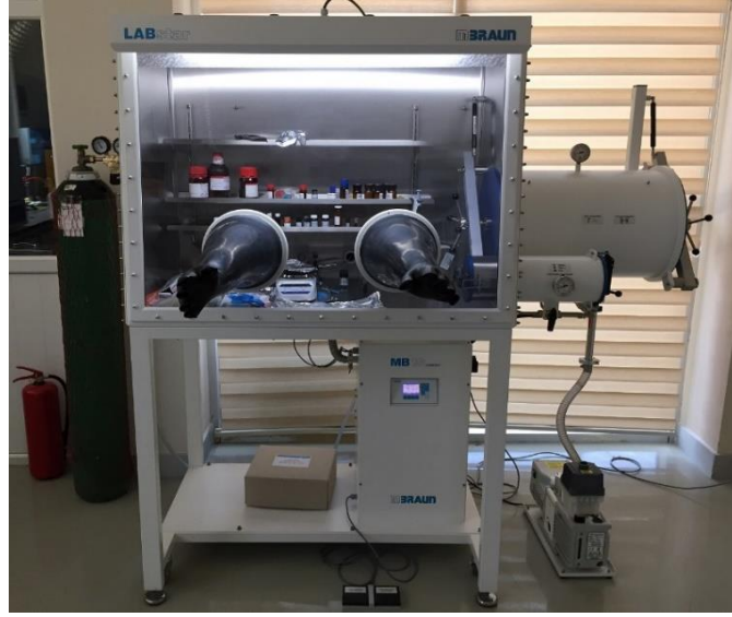
Şekil 3.1. Çözelti hazırlama ve materyal muhafazasında kullanılan glove box
