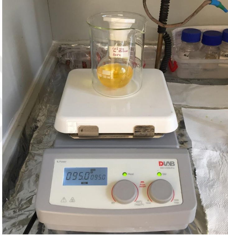
Şekil 3.8. CdS ince film eldesi için ultrasonik spray piroliz cihazında kullanılan çözelti
