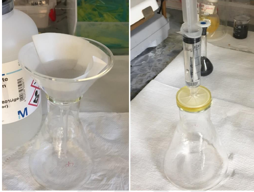
Şekil 3.11. CdTe ince film eldesi için filtreleme işlemlerinden geçirilen çözelti
