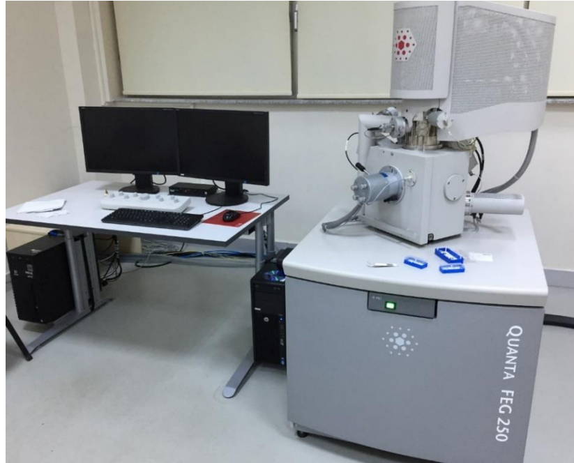
Şekil 3.4. İnce filmlerin yapısal analizinde kullanılan taramalı elektron mikroskobu
