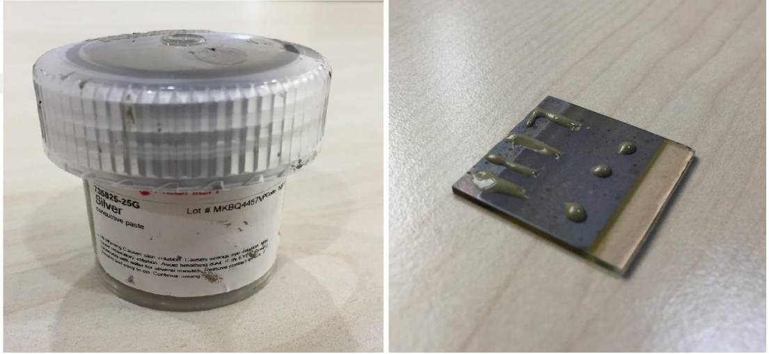
Şekil 3.14. Kontak işleminde kullanılan gümüş pasta ve işlemleri tamamlanan hücrelerin görünümü
