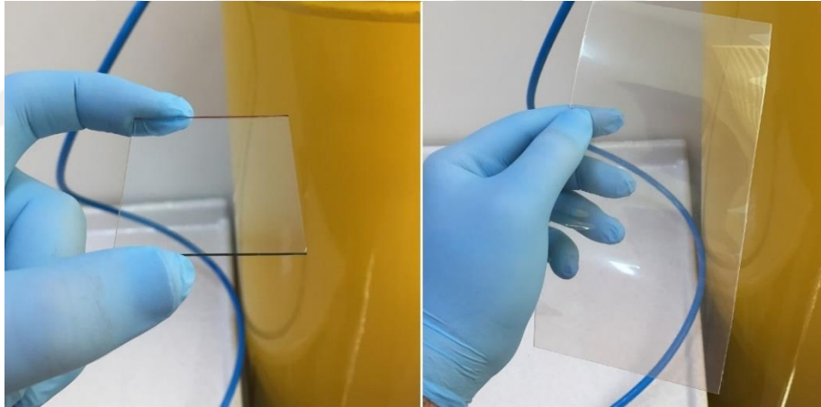
Şekil 1.11. ITO kaplı cam (sol) ve pet (sağ) altlıkların görünümü
