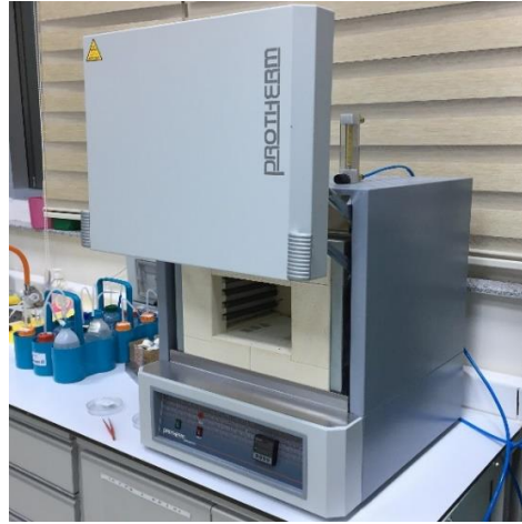
Şekil 3.2. İnce filmlerin tavlama işlemi için kullanılan kül fırını
