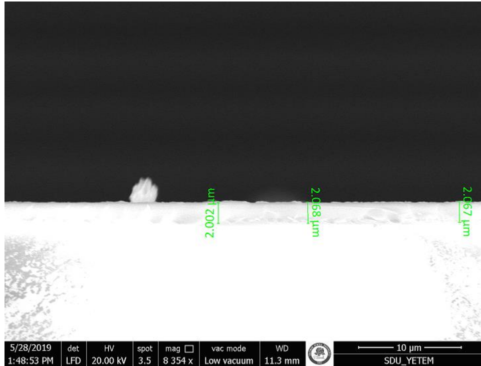
Şekil 4.2. 25 pas sayısına sahip CdTe ince film kesitinin SEM görüntüsü
