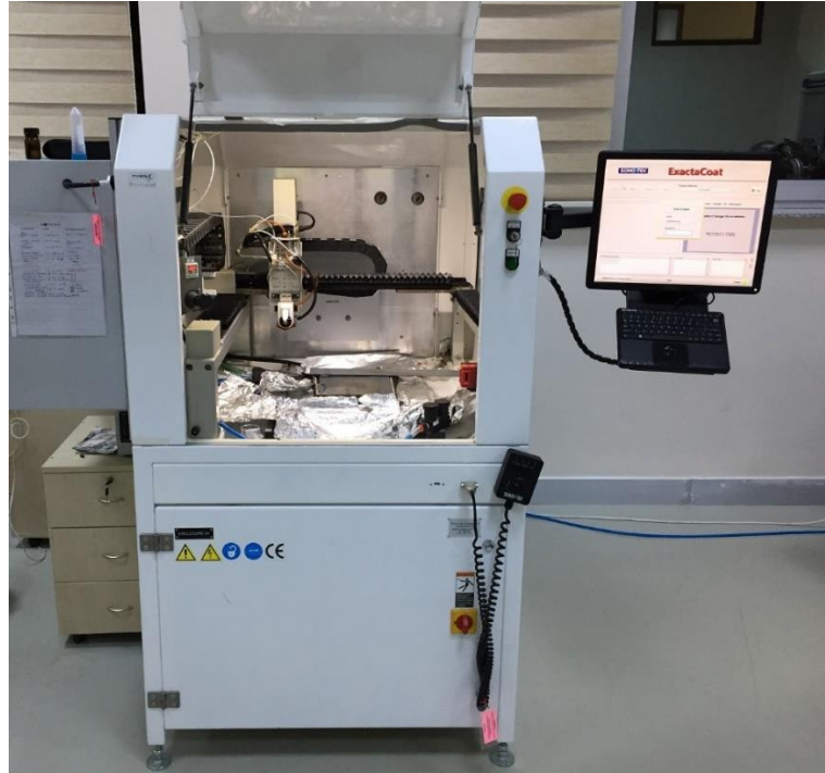
Şekil 3.3. İnce film üretimi için kullanılan ultrasonik sprey piroliz cihazı
