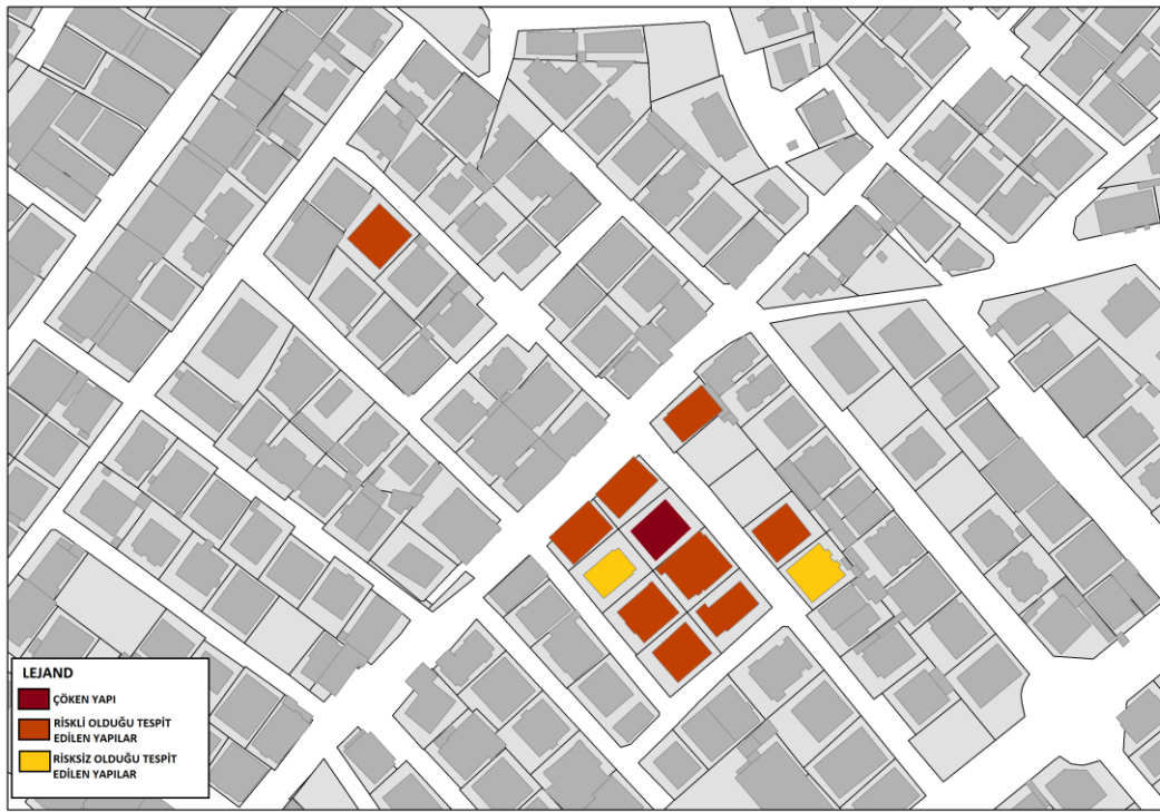
Şekil 5. 22 Orhantepe Mahallesi çalışma alanındaki re'sen tespit yapılan yapıların dağılımı 1
