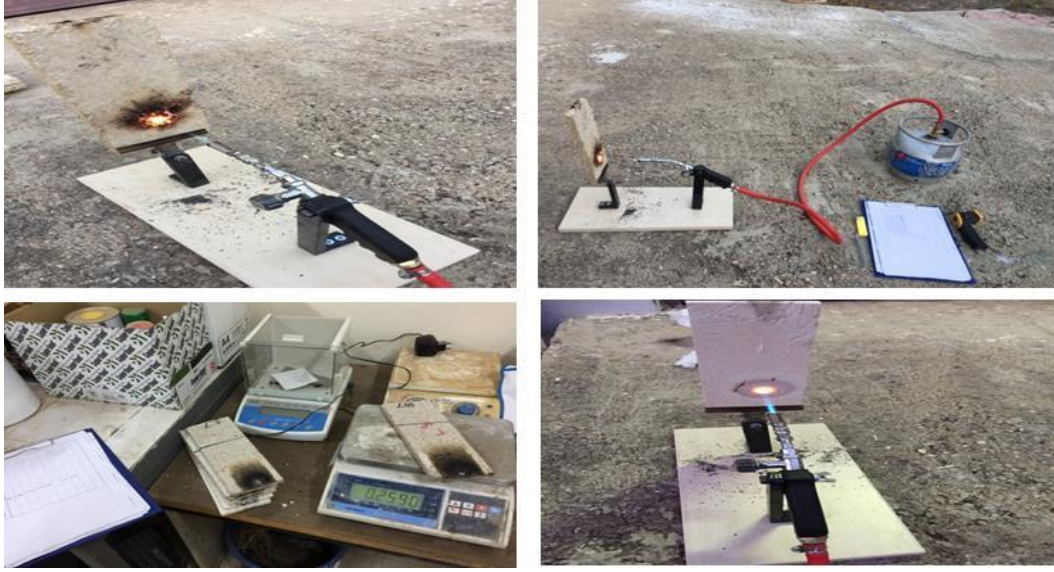
Şekil 12. Deneme levhalarının yanma davranışı tespiti (Foto: İlkhan Demir, 2018).
