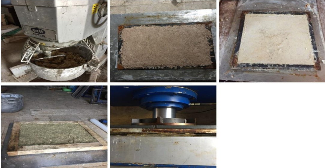
Şekil 9. Deneme levhalarının üretim aşamaları (Foto: İlkhan Demir, 2018).
