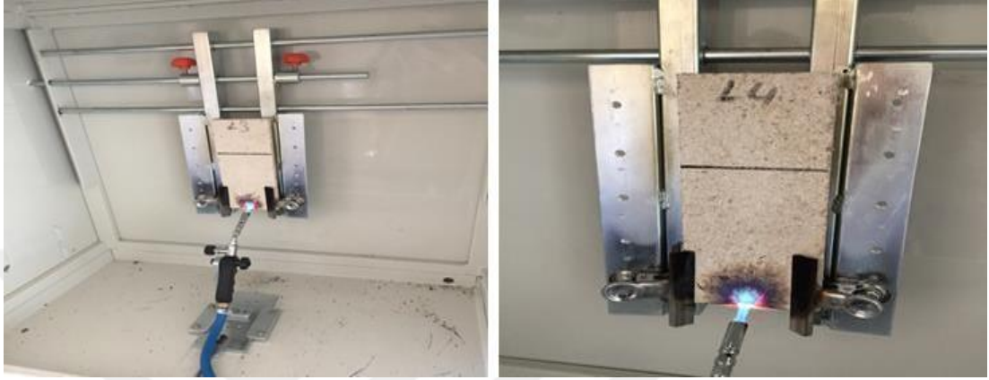
Şekil 11. Deneme levhalarının tek kaynaklı alev testi (Foto: İlkhan Demir, 2018).
