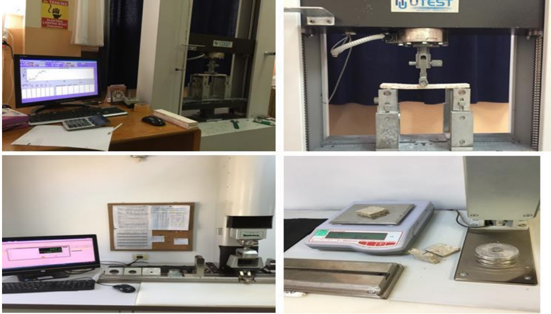
Şekil 10. Deneme levhalarının mekanik direnç özelliklerinin tayini (Foto: İlkhan Demir, 2018).
