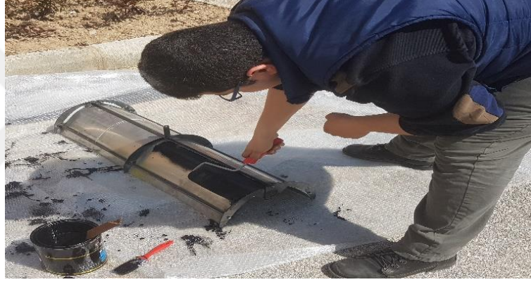
Şekil 3.15. Parabolik olukların arka yüzlerinin boyanması
