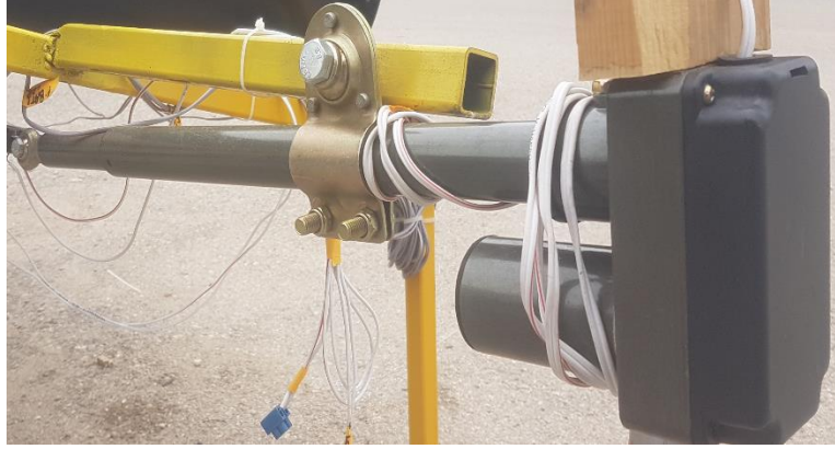
Şekil 3.29. TZC marka HARL3612+ model lineer hareketli DC aktuatör
