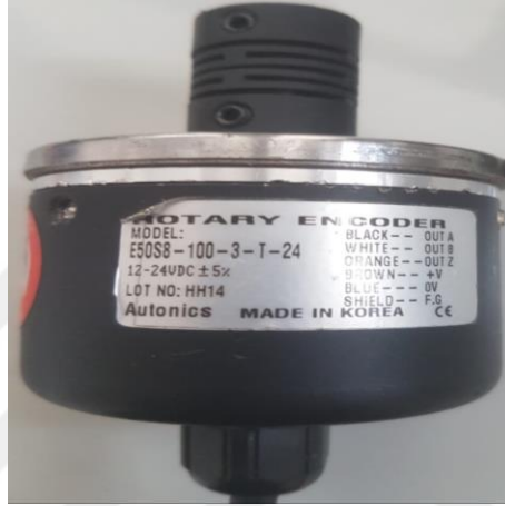
Şekil 3.31. Autonics marka E80S8-100-3-T-24 model dönersel enkoder
