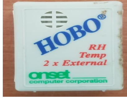
Şekil 3.60. Hobo H08-004-02 datalogger
