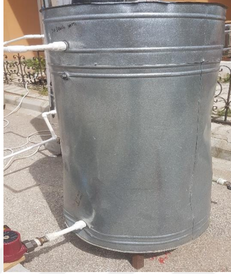
Şekil 3.19. Sistemde kullanılan su deposu
