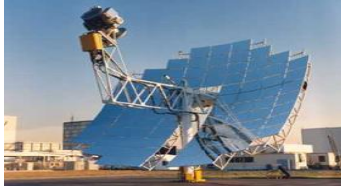
Şekil 1.9. Parabolik çanak tipi kollektörler (YEGM, 2019c)
