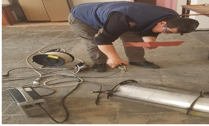
Şekil 3.14. Parabolik olukların kafes imalatı
