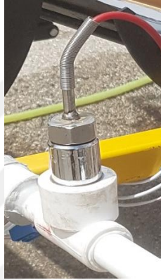
Şekil 3.57. Almemo’da kullanılan termokupl
