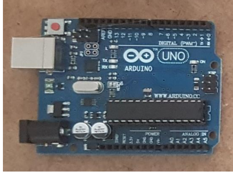
Şekil 3.27. Arduino Uno mikrodenetleyici kontrol kartı
