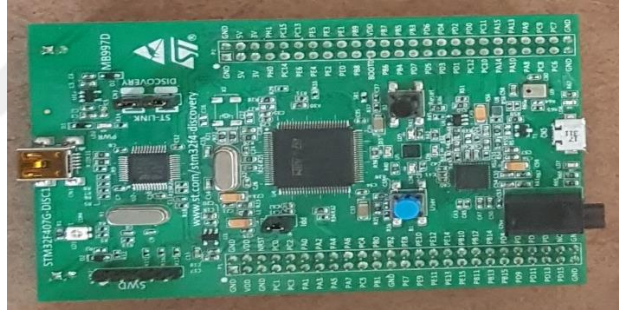
Şekil 3.48. STM32F407G mikrodnetleyici kontrol kartı
