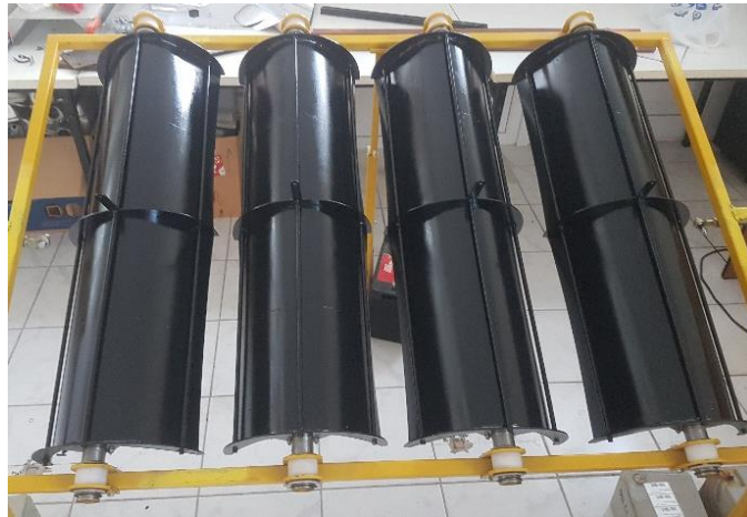
Şekil 3.16. İmalatı tamamlanan parabolik olukların üst şasiye montajı
