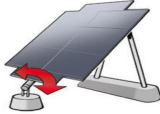
Şekil 1.26. Dikey eksenli güneş takip sistemi (Önal, 2009)
