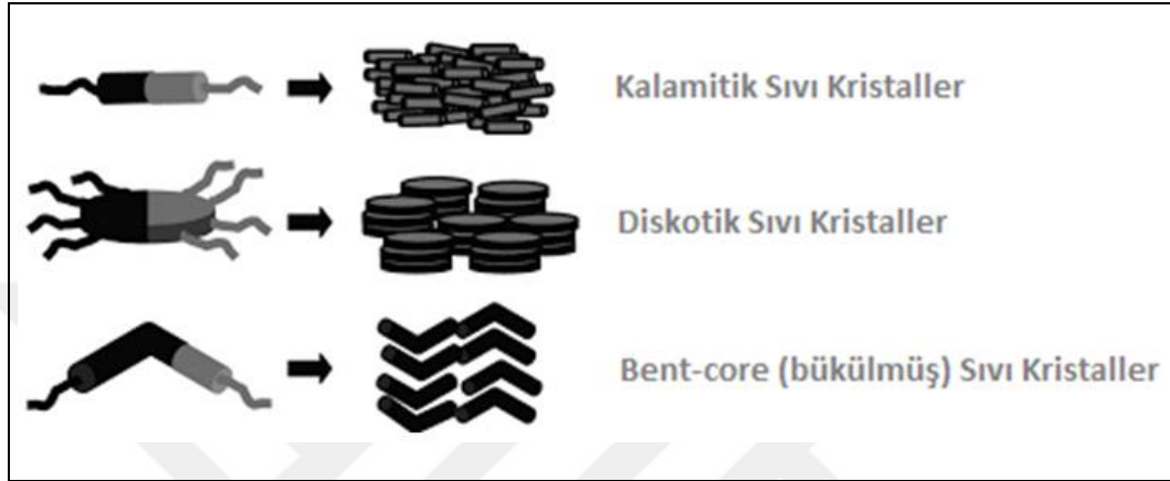
Şekil 2.8 Molekül geometrilerine göre sıvı kristallerin şematik gösterimi [13].
