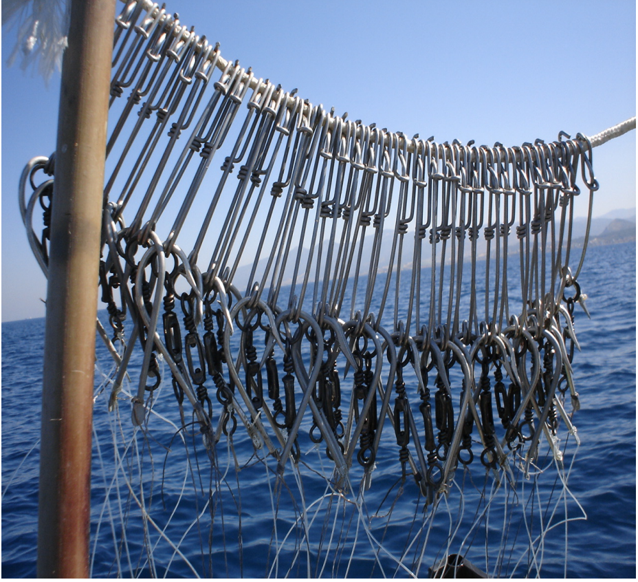
Şekil 2.5. Yemlenecek kösteklerin görünümü
