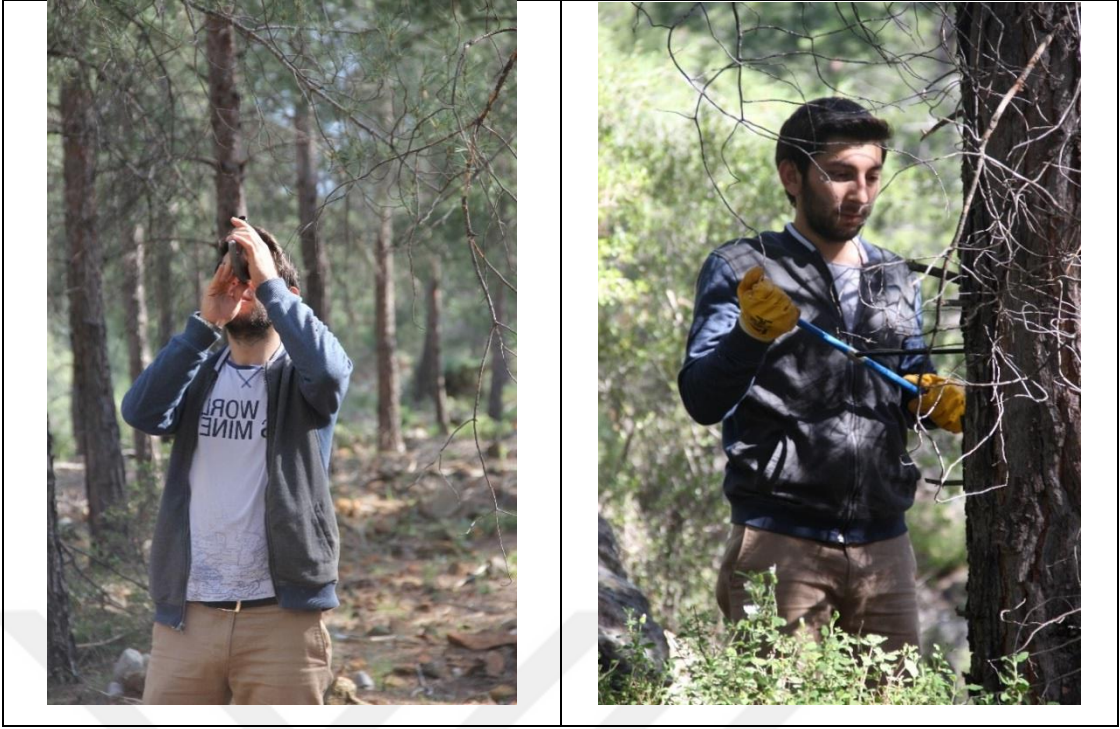
Şekil 3.3. Örnek alanda Blume Liess ile boy, artım burgusu ile yaş ölçümü
