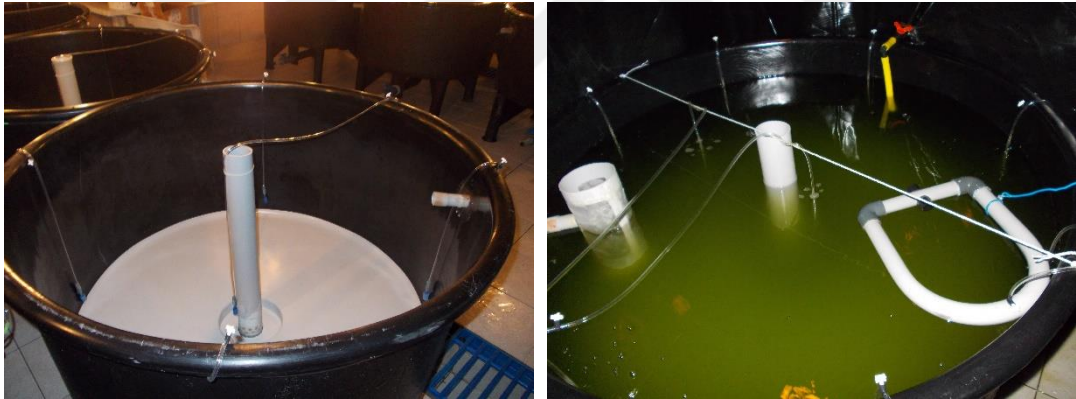
Şekil 3.3. Deneme tanklarındaki havalandırma ve su sistemi
