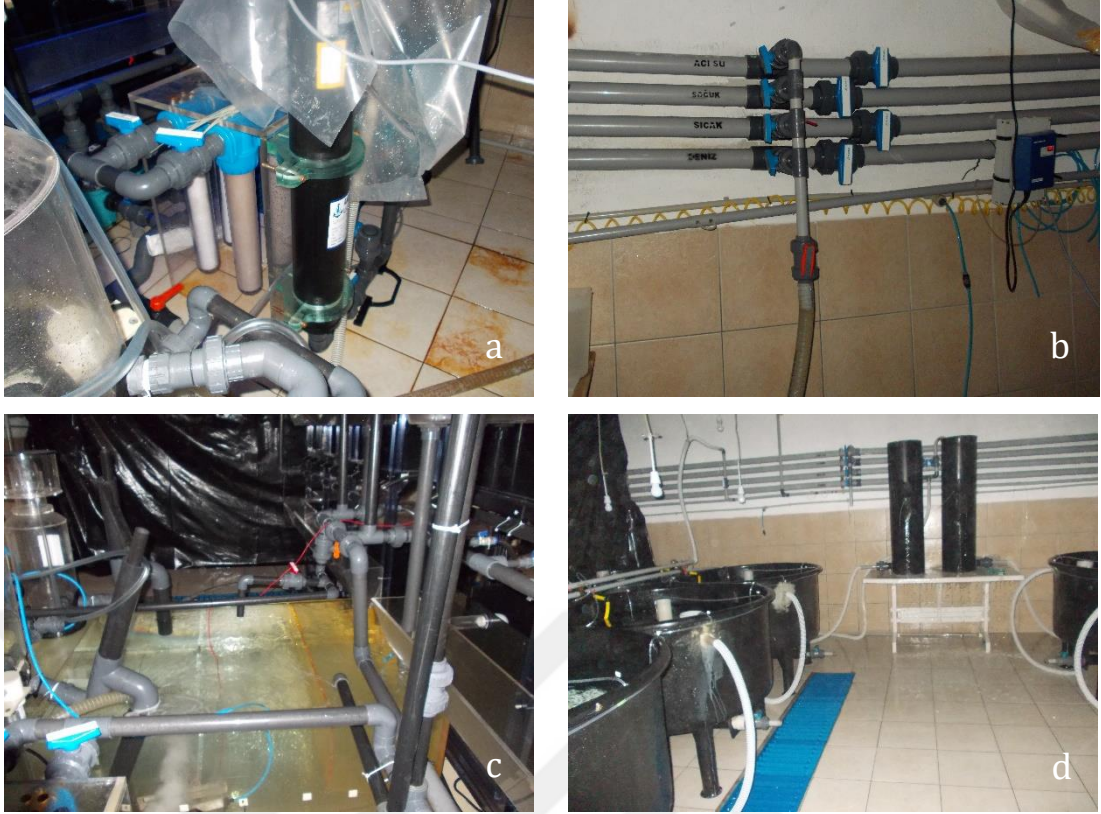
Şekil 3.1. Suyun deneme tankları için hazırlanması a)Suyun filtrasyonu,ultraviole ile dezenfeksiyonu, b) tuzluluğun ve sıcaklığın ayarlanması, c)karışım tankı d)saturasyon kolonu ile suyun tanklara ulaştırılması
