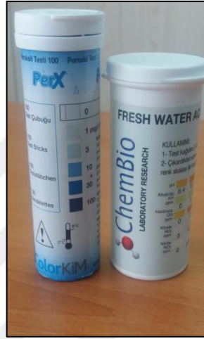
Şekil 3.8. H_2O_2 ölçümleri için chembio marka test şeritleri (solda), NO_2 ve NO_3 ölçümleri için colorkim marka test şeritleri (sağda)
