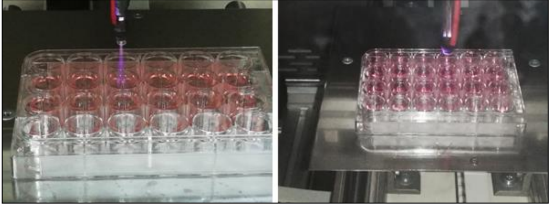
Şekil 4.48. Hücre kültürü deney gruplarına 7 kV-50 kHz parametrelerinde 5 L/dk akış hızında oluşturulan He plazma uygulaması (solda), Hücre kültürü deney gruplarına 7 kV-50 kHz parametrelerinde 5 L/dk akış hızında oluşturulan Ar plazma uygulaması (sağda)
