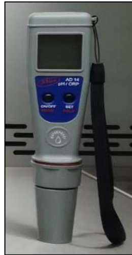
Şekil 3.7. Adwa marka AD14 model pH metre: pH, ORP, sıcaklık ölçüm cihazı
