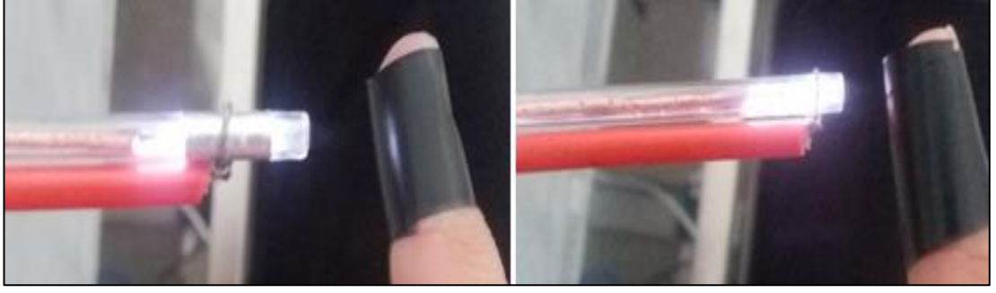
Şekil 3.20. 7 kV, 50 kHz DC güç kaynağı kullanılarak 5 mm çapta cam boruda Al bantlı oluşturulan Ar plazma (solda), 5 mm çapta cam boruda Al bant olmadan oluşturulan Ar plazma (sağda)
