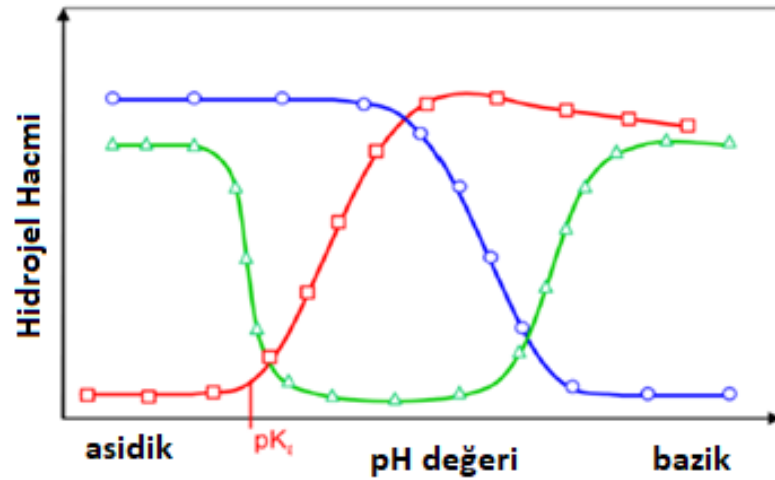
Şekil 2.7 pH duyarlı hidrojellerin hacim-faz geçişleri; kırmızı: anyonik/asidik hidrojel, mavi: katyonik/bazik hidrojel, yeşil: amfifilik hidrojel göstermektedir [119]
