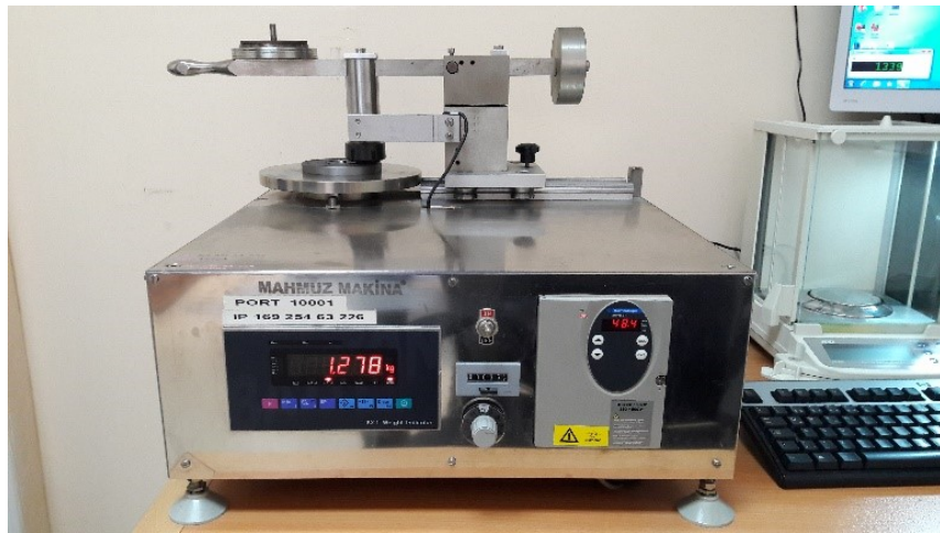
Şekil 3.2 Pin-on-Disk deney düzeneği görseli
