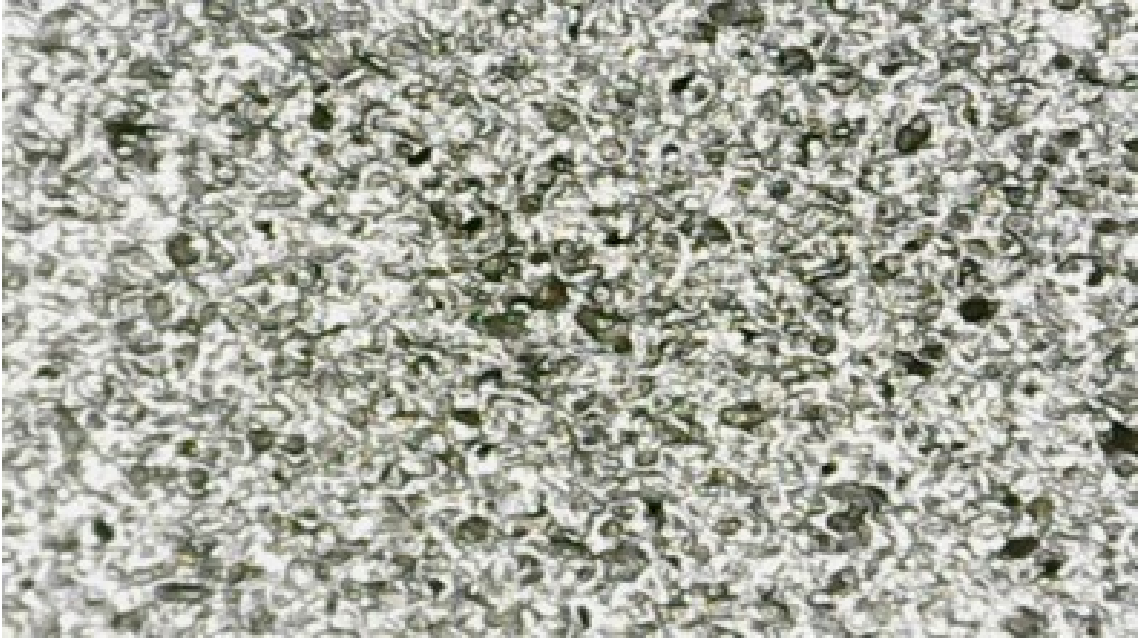
Şekil 4.63 20 VDI çelik diskin deney sonrası elektronik mikroskop ile yüzey görüntüsü
