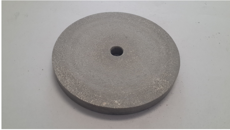
Şekil 3.10 Deney sonrası 45 VDI çelik
