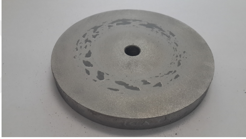
Şekil 3.9 Deney sonrası 30 VDI çelik
