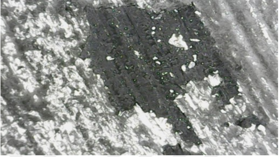
Şekil 4.62 Dökme demir disk yüzeyindeki çatlakta biriken grafen kalıntısı
