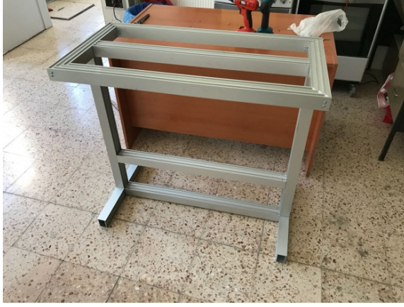
Sekil 3.1. Sabit çok panelli güneş sisteminin gövde tasarımı
