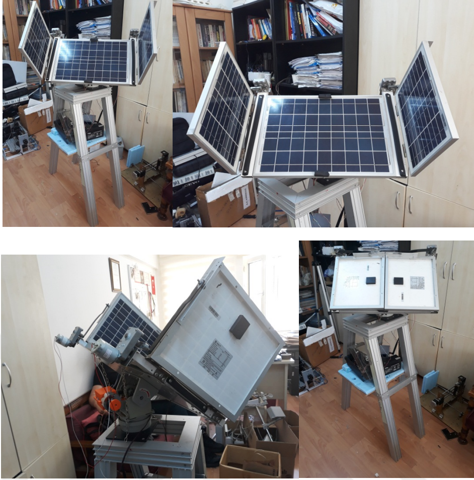
Şekil 3.4. Güneş takipli sisteminin PV güneş pillerinin açık ve kapalı hali
