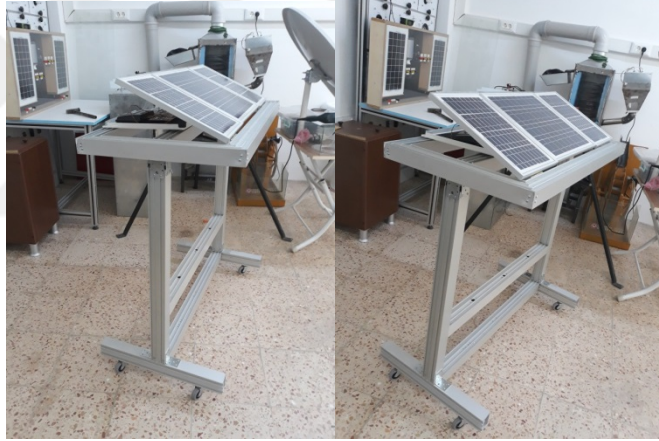
Şekil 3.2. Sabit çok panelli güneş sisteminin PV panellerinin monte edilmiş hali
