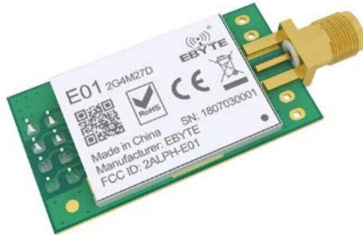
Şekil 3.16. nRF24L01 kablosuz haberleşme modülü
