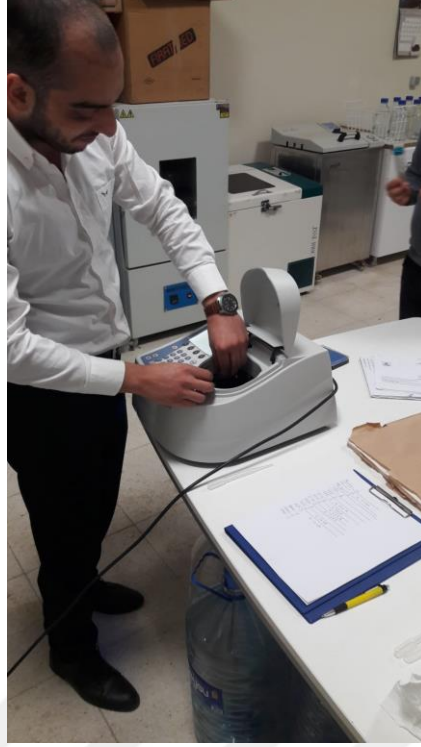
Şekil 3.11. Ekstraksiyon işlemi sonucu elde edilen renk maddelerinin absorbands ölçümleri
