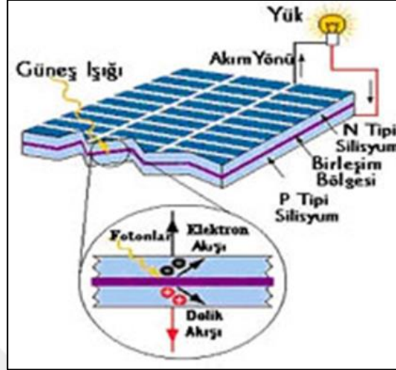
Şekil 1.13. Güneş pillerinin çalışma ilkeleri (Erkul, 2010)
