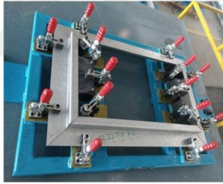
Şekil 3. 4 Elle İşletilen Kaynak Fikstürü [33]
