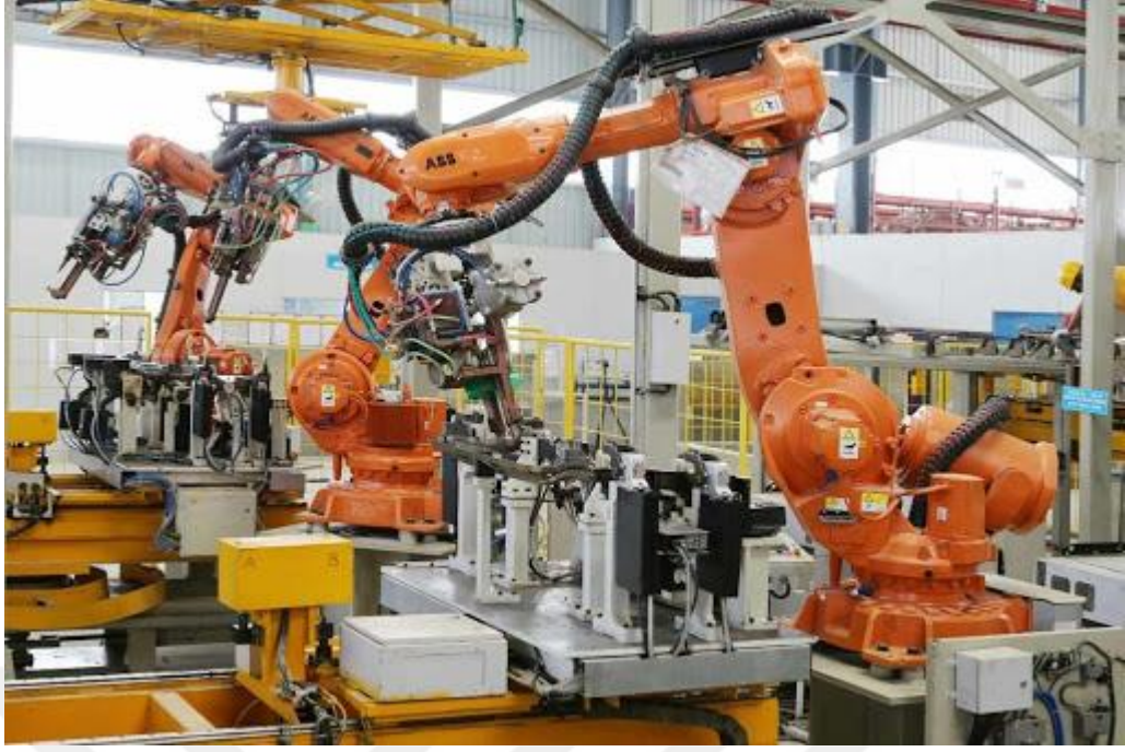
Şekil 3. 5 Robot Kaynak Fikstürü [34]
