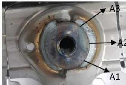
Şekil 4. 17 Kesme Testi Analizinde Kullanılan Kesme Bölgeleri
