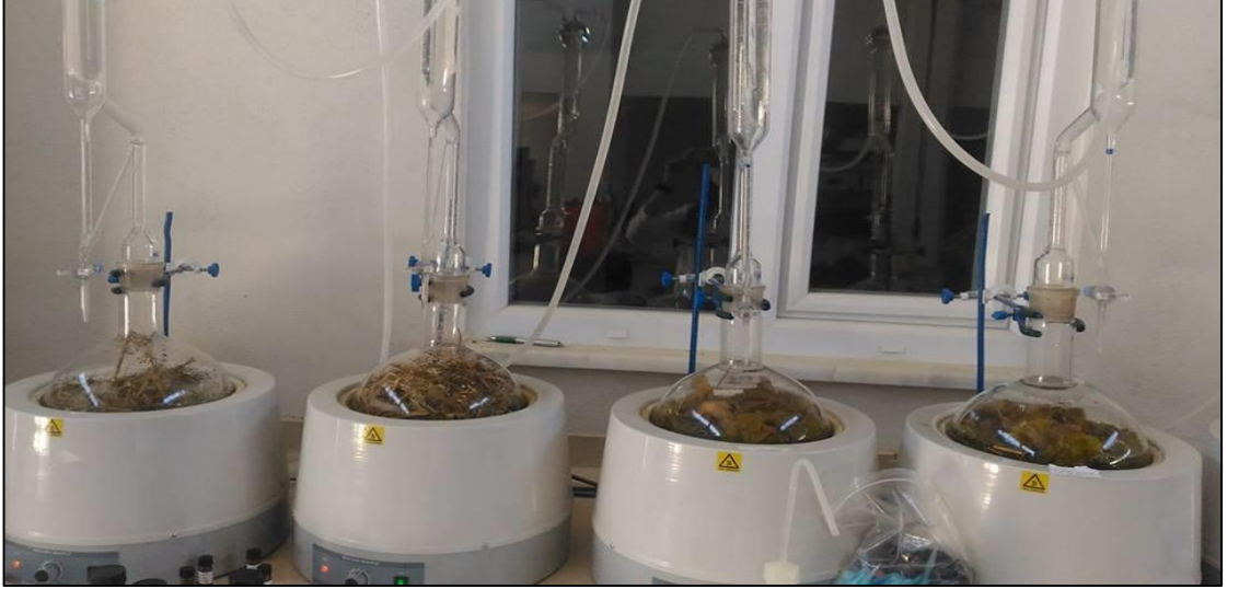
Şekil A.8. Uçucu yağların clevenger cihazı ile elde edilmesi
