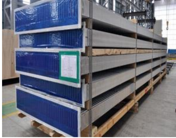
Şekil 5.5 Hava soğutmalı kondenserin tüp demeti (Energyen Corporation, 2015)
