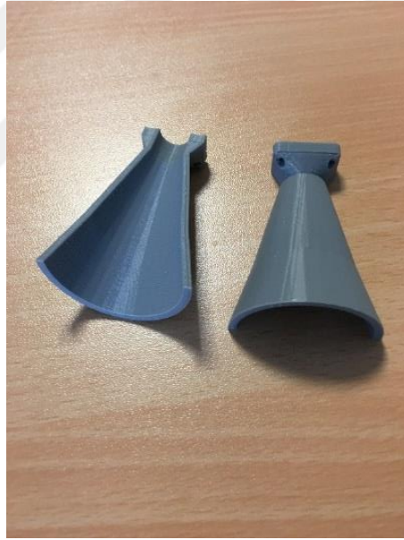
Şekil 7. 73 3D yazıcıda üretilmiş huni anten
