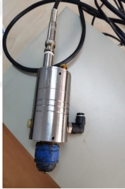
Şekil 3.8. 50kHz ultrasonik atomizer
