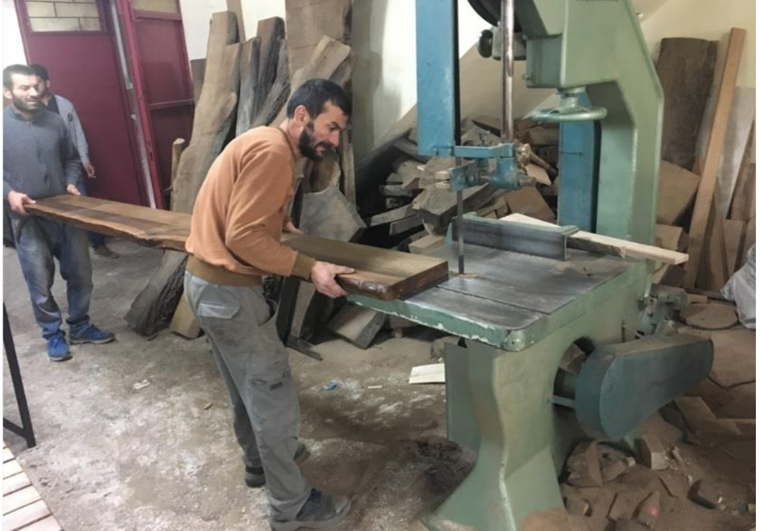
Şekil 3.5. Ahşap masa yapımı aşamalarında şerit testere kullanımı [Foto. M. Can HAKYEMEZ 2019]
