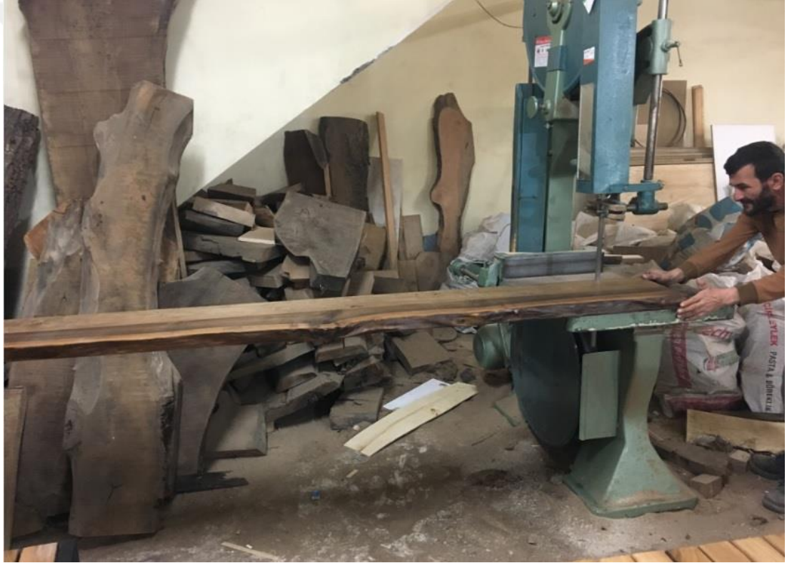
Şekil 3.6. Şerit testere ile ahşap masanın istenilen ölçülere getirilmesi [Foto. M. Can HAKYEMEZ 2019]
