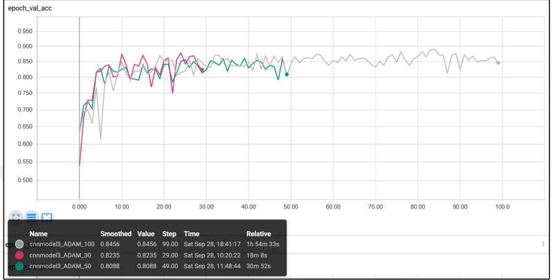
Şekil 4.6. Önerilen CNN modelinin farklı iterasyon sayılarında eğitimi sonucu doğruluk oranlarının karşılaştırılması
