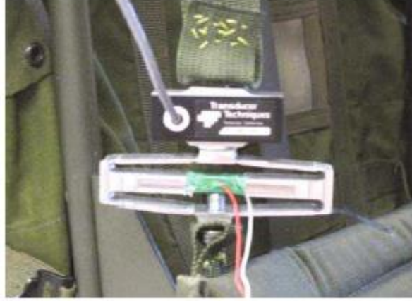
Şekil 1.23. Sırt çantası için tasarlanan piezoelektrik enerji hasatı sistemi (Avşar ve Şahin, 2012).
