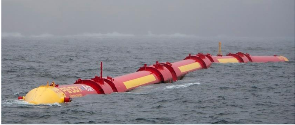
Şekil 1.12. Pelamis örneği (Anonim, 2012a).
