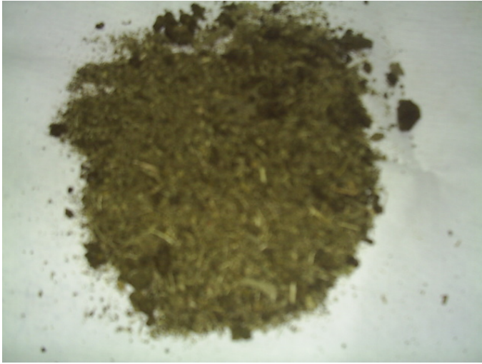
Şekil 3.8. Maksimum glikozit veriminin alındığı 250 bar, 60°C, %20 yardımcı çözügen oranı çalışma koşullarında elde edilen posa.
