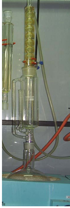
Şekil 3.2. Soxhlet ekstraktörü ile gerçekleştirilen S. rebaudiana çözen ekstraksiyonu
