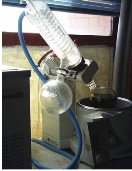
Şekil 3.3. Vakumlu evaporatörde S. rebaudiana çözgen ekstresi
