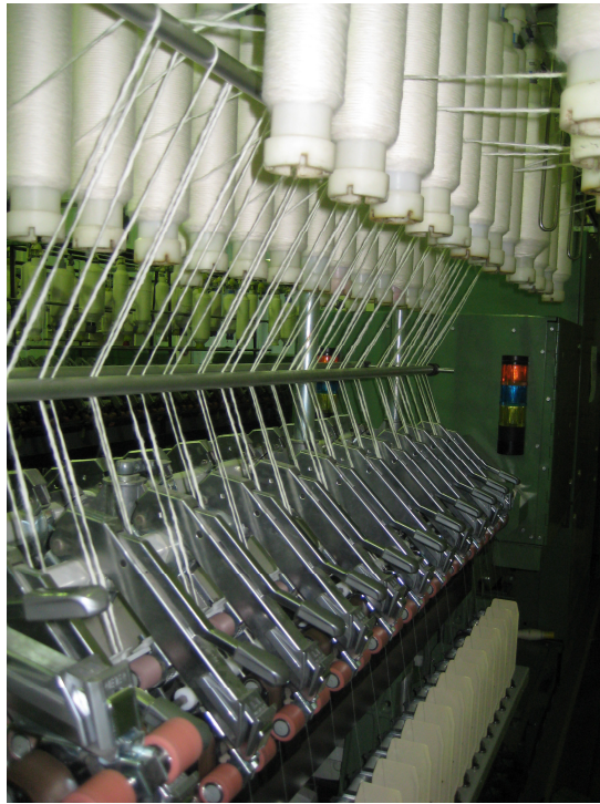
Şekil 3.3 Siro iplik üretiminde çağlık ve fitil yerleşimi düzeni.
