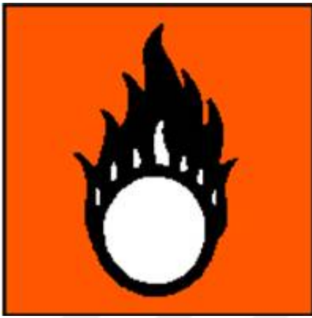
Resim G1: Oksitleyici (Türkiye’de piyasada bulunan etiketlerin üzerinde ki semboller, gösterildiği gibi siyah çerçeve, turuncu zemin üzerine siyah baskılı piktogram olarak gösterilmiştir. GÜVENLİK BİLGİ FORM Market 2014).
